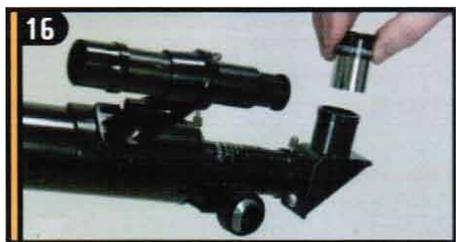
16 Установите посадочную хромированную втулку окуляра в отверстие диагонали и закрепите винтом-фиксатором.
