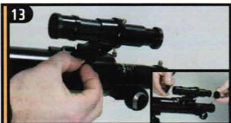
13 Снимите защитные колпачки с объектива и окуляра искателя.
