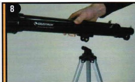
Установите трубу телескопа на азимутальную монтировку, совместив отверстие в посадочной площадке трубы с отверстиями в головке треноги.
