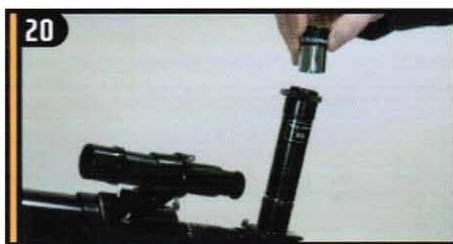
20 Вставьте посадочную втулку окуляра в линзу Барлоу и закрепите окуляр винтом - фиксатором расположенным на линзе Барлоу.
