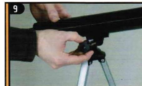
Вставьте винт блокировки по высоте через отверстие в головке треноги и посадочной площадке трубы и затяните его.
