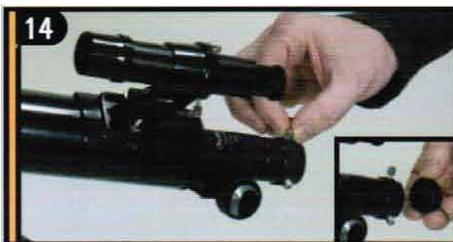
14 Снимите защитную крышку с окулярного узла.
