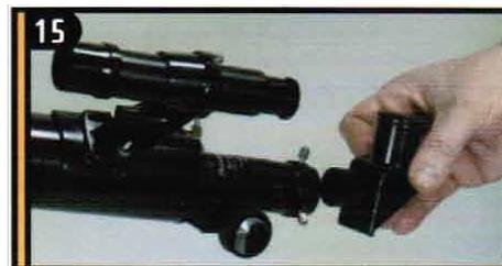
15 Вставьте посадочную втулку диагональной призмы в окулярный адаптер фокусировочного узла телескопа. Затяните фиксирующие винты.
