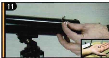
11 Снимите гайки с насечкой со шпилек, расположенных на трубе возле фокусировочного узла.
