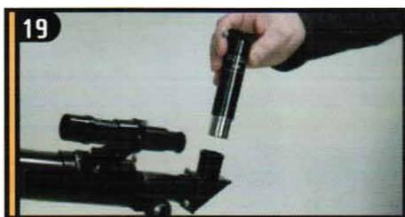
19 Установите в диагональную призму линзу Барлоу и закрепите ее винтом фиксатором.
