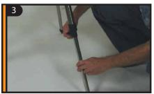
Для фиксации штатива по высоте затяните фиксаторы, расположенные на каждой опоре.
