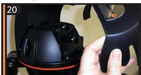
20 Для установки батареек в телескоп нажмите на выступы по обеим сторонам крышки отделения для батареек и потяните вверх. Вставьте 8 батареек типа AA в держатели отделения для батареек.
