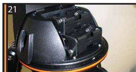
21 Установите крышку на место и надавите до щелчка. Переведите переключатель в положение "On". При включении загорится индикатор питания.
