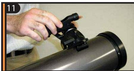
11 Для установки искателя, ослабьте крепежный винт на установочной платформе и вставьте в нее искатель, как показано выше на рисунке.
