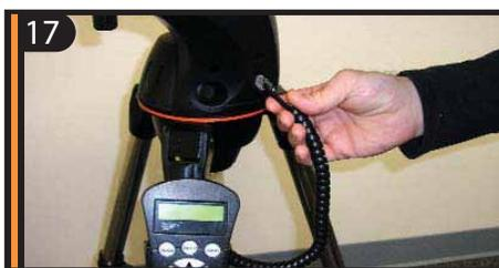
17 Вставьте его в гнездо порта "Hand Control", расположенное в основании монтировки телескопа так, чтобы он защелкнулся.
