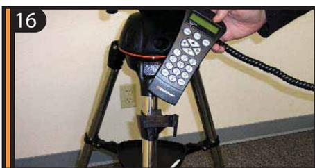
16 Установите пульт управления в держатель. Пульт управления NexStar оснащен кабелем с разъемом телефонного типа.
