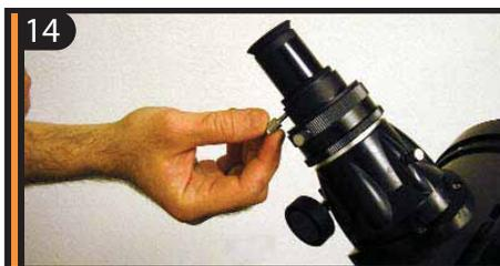
14 Вставьте хромированную посадочную втулку окуляра в трубку фокусирующего узла и закрепите окуляр винтом фиксатором.
