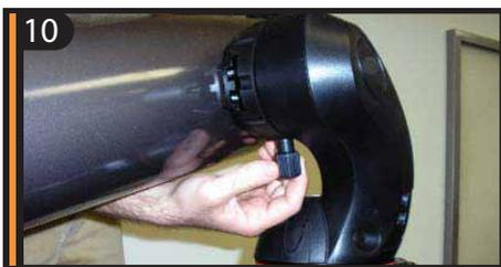
10 Прочно закрепите трубу на монтировке, вручную затянув зажимной винт.
