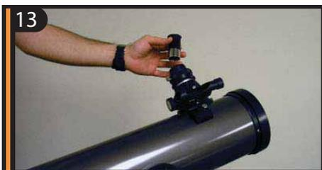
13 Ослабьте винты фиксаторов окулярного адаптера, а так же снимите крышку с адаптера. Выберите окуляр с меньшим увеличением (25 мм).
