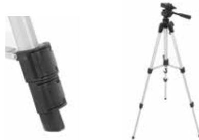
3. Если требуется еще увеличить высоту штатива, найдите фиксатор центральной колонны штатива. Ослабьте фиксатор поворотом против часовой стрелки. Затем выдвиньте центральную колонну до достижения желаемой высоты и зафиксируйте ручку-фиксатор.
