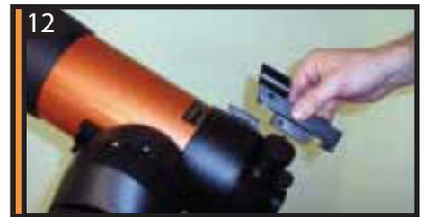
Установите пластину искателя на пластину типа "ласточкин хвост". Передняя часть искателя должна выступать вперед вдоль трубы телескопа. Завинтите два винта.
