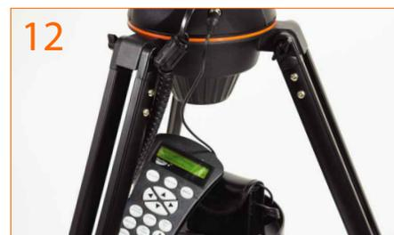
12. Ваш телескоп не имеет выключателя вкл / выкл, поэтому, просто подключите шнур батарейного блока в гнездо питания телескопа. Телескоп NexStar включится, при этом загорится красная подсветка на пульте управления.
