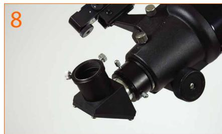
8. Ослабьте винты фиксаторов окулярного адаптера, а так же снимите крышку с адаптера. Установите диагональное зеркало и зафиксируйте его винтом.
