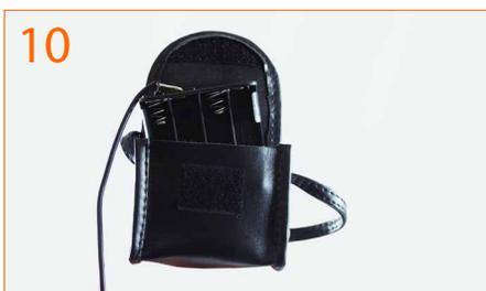
10. Откройте мешочек аккумуляторного блока и выньте из него батарейный отсек. Вставьте новый набор из 8 батарей AA в гнезда батарейного отсека, убедитесь, что вы вставили их правильной полярностью (+/-).
