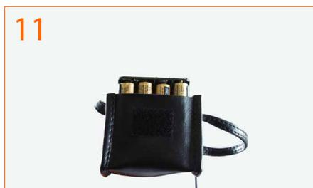
11. Вставьте батарейный отсек обратно в чехол и поместите его в лоток для принадлежностей. Вставьте шнур из батарейного блока в гнездо питания расположенное на основании монтировки.
