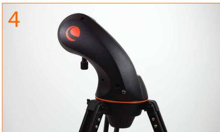
4. Вставьте основание вилочной монтировки в посадочную площадку треноги, как показано на картинке. Закрутите зажимной винт в отверстие в нижней части основания монтировки и затените его вручную.
