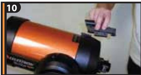
10 Установите пластину искателя на пластину типа "ласточкин хвост". Передняя часть искателя должна выступать вперед вдоль трубы телескопа. Завинтите два винта.
