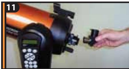
11 Ослабьте винты фиксаторов окулярного адаптера, а так же снимите крышку с адаптера. Установите диагональное зеркало и зафиксируйте его винтом.
