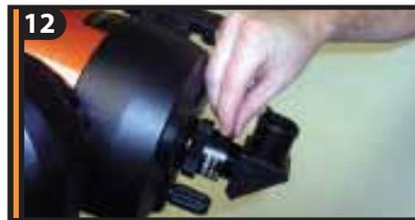
12 Установите диагональное зеркало и зафиксируйте его винтом.
