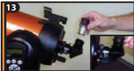
13 Вставьте хромированную посадочную втулку окуляра в трубку фокусирующего узла и закрепите окуляр винтом фиксатором.
